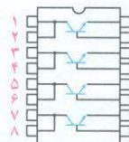
چهار ترانزیستور در یک محفظه برای نصب سطحی
