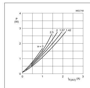
$a = I_{F(RMS)}/I_{F(AV)}; \ V_R = V_{RRMmax}; \ \delta = 0.5.$
