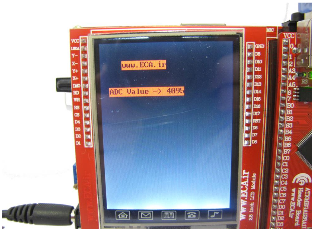
[۴] ADC: راه اندازی واحد ADC مبدل آنالوگ به دیجیتال و نمایش ولتاژ اعمالی توسط مولتی ترن در صفحه نمایش
