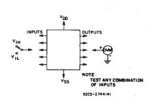
Fig. 12 - Input-voltage test circuit.
