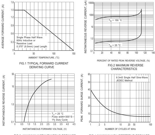
FIG.3 MAXIMUM INSTANTANEOUS FORWARD CHARACTERISTICS
