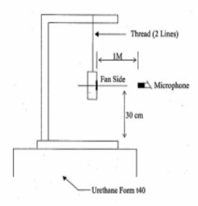
1 METER FROM MICROPHONE TO FAN INTAKE
