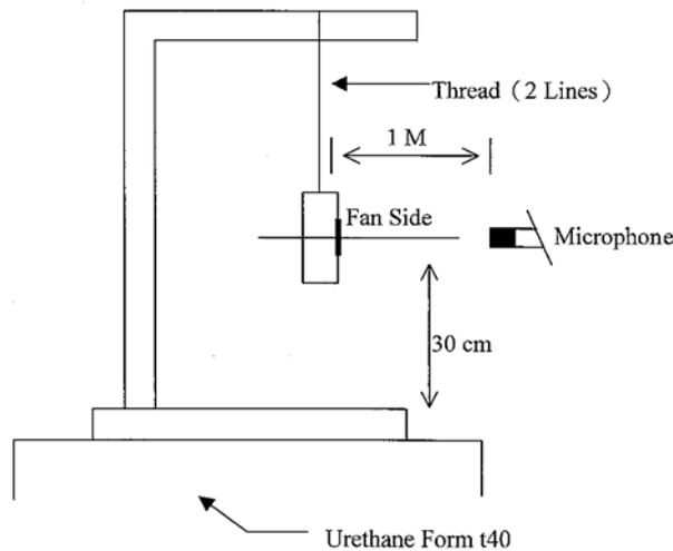
1 METER FROM MICROPHONE TO FAN INTAKE
