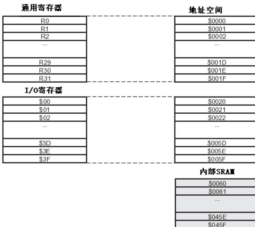
32 个通用寄存器被编址到最前，I/O 寄存器占用接下来的 64 个地址。从 0X0060 开始为内部 SRAM。外部 SRAM 被编址到内部 SRAM 后。
