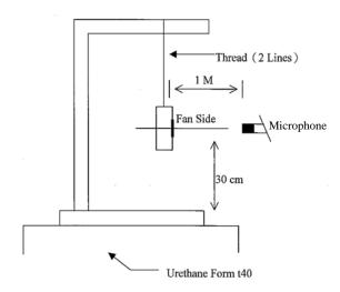
1 METER FROM MICROPHONE TO FAN INTAKE
