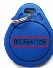
برای تبدیل کد هگز اصلی کارت به کد یونیک ۱۰ رقمی چاپ شده روی کارت، ۳ بایت کم ارزش را از مبنای هگز به مبنای ۱۰ تبدیل کنید و عدد بدست آمده را به فرمت ۱۰ رقمی قالب بندی کنید. برای مثال: کد هگز این کارت '1E009BC42' میباشد و با تبدیل ۳ بایت کم ارزش به مبنای ۱۰ شماره‌ی 638018 بدست می‌آید. با قالب بندی این عدد به عدد ۱۰ رقمی میشود 0000638018.
