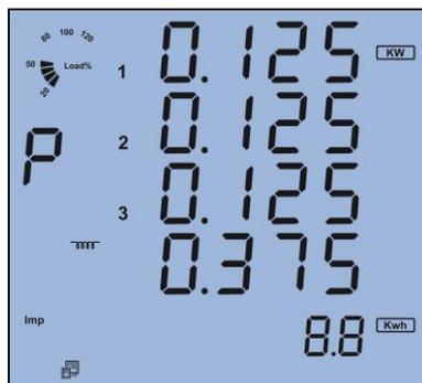
صفحه اول توان: دکمه P را فشار دهید نمایشگر به صفحه مربوط به توانها می رود. نمایش دهنده توان هر فاز شامل P3, P2, P1 و توان کل
