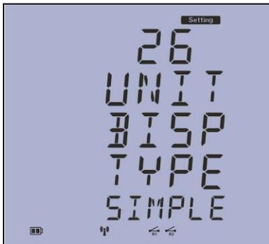
صفحه بیست و ششم: نشان دهنده نوع نمایش کمیت‌های دستگاه که به دو صورت simple و full میباشد که بهنگام نمایش کمیت‌های اندازه گیری شده در صفحات نمایش دستگاه دو حالت متفاوت را نمایش میدهد مثلاً در حالت full امکان نمایش فرکانس و هارمونیک‌های جریان و ولتاژ تا هارمونیک ۳۲ بصورت تک تک وجود دارد.
