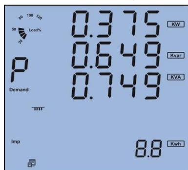
صفحه هفتم: نمایش دیمانند توان کل سیستم است که  $Dmd-P$ : دیمانند توان اکتیو،  $Dmd-Q$ : دیمانند توان راکتیو و  $Dmd-S$ : دیمانند توان ظاهری سیستم است که مطابق شکل ۱۲-۳ بصورت زیر است.
