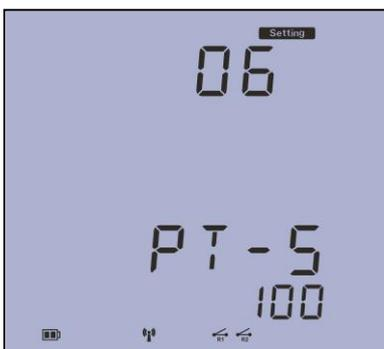
صفحه ششم: منوی تنظیم مقدار ثانویه PT می باشد که می تواند مقداری بین ۱۰۰ تا ۴۰۰ باشد. واحد آن ولت و مطابق شکل بر روی ۱۰۰ تنظیم شده است. با فشار کلیدهای P و E امکان تغییر مقادیر وجود دارد. با فشار دکمه V مقدار ثبت شده و به صفحه بعد می رویم.
