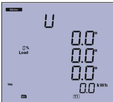
صفحه سیزدهم: در این صفحه مقدار نامتقارنی بین فازها برای ولتاژ شبکه در هر فاز بصورت درجه اندازه گیری و نمایش داده میشود.
