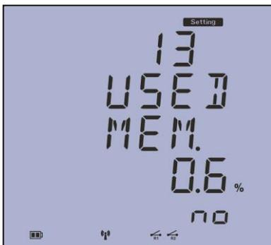
صفحه سیزدهم: در این منو وضعیت حافظه داخلی دستگاه به نمایش درمی آید و درصد حافظه استفاده شده را نشان می دهد. اگر حافظه پر شود پیغام FILL نمایش داده می شود. همچنین در سمت چپ تعداد رکوردها نیز نمایش میابد با فشار دکمه P و یا E پیغام ERASE داده می شود که در صورت خواست شما می توانید با فشار دکمه V و وارد کردن کد رمز نسبت به پاک کردن حافظه داخلی اقدام نمایید و پس از آن پیغام MEM ERASED نمایش داده می شود.
