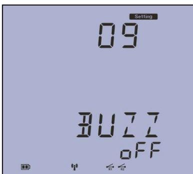
صفحه نهم: منوی روشن و یا خاموش کردن بزر دستگاہ میباشد. لازم به ذکر است بزر دستگاہ بهنگام فشار دگمه ها به صدا در می آید.
