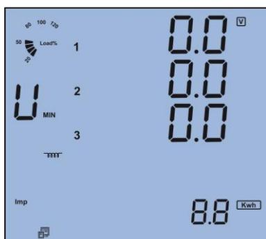
با فشار دکمه P تعداد کمینه ولتاژ نمایش داده می شود و برچسب min در گوشه سمت راست پائین U نمایش داده می شود. با فشار
