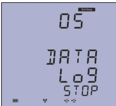
صفحه پنجم : این جهت شروع و یا توقف نمونه برداری دستگاه بوده که در دو حالت START و STOP بوده و نشاندهنده انجام و یا عدم انجام نمونه برداری میباشد.
