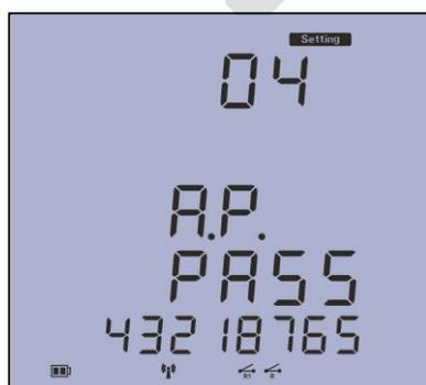
صفحه چهارم: این صفحه جهت تغییر و اختصاص رمز ورود ACCESS POINT بکار میرود. جهت اتصال از طریق کامپیوتر یا تبلت به دستگاه وارد نمودن این رمز عبور الزامی میباشد.
