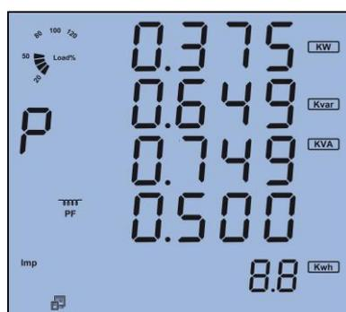
صفحه پنجم: در صفحه پنجم توان اکتیو کل سیستم  $P_{tot}$  و توان راکتیو سیستم  $q_{tot}$  و توان ظاهری کل سیستم  $Stot$  و متوسط پاور فاکتور کل سیستم نمایش داده می شود. که طبق شکل ۱۵-۳ بصورت زیر است.
