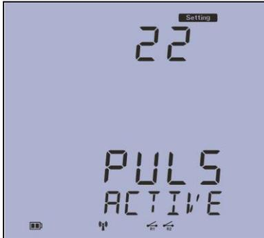
صفحه بیست و دوم: نشانگر led موجود در جلوی دستگاه که نمایش دهنده انرژی مصرفی دستگاه میباشد از طریق این منو انرژی اکتیو یا راکتیو را انتخاب کرده و میزان مصرف آن از طریق led چشمک زن با ضریب پالس انتخابی در منو ۲۳ قابل اندازه گیری میباشد.
