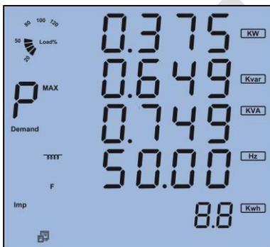
صفحه پنجم: مقدار بیشینه دیمانند و فرکانس را نشان می دهد. مطابق شکل مقدار بیشینه دیمانند توان سیستم  $Dmd-P-max=0.375KW$  و مقدار بیشینه دیمانند توان راکتیو  $Dmd-Q-max=0.649Kvar$  و مقدار بیشینه دیمانند توان ظاهر سیستم  $Dmd-S-max=0.749KVA$  و مقدار بیشینه فرکانس سیستم برابر  $50HZ$  می باشد. با فشار دکمه P از نمایشگر max به نمایشگر min می رویم.
