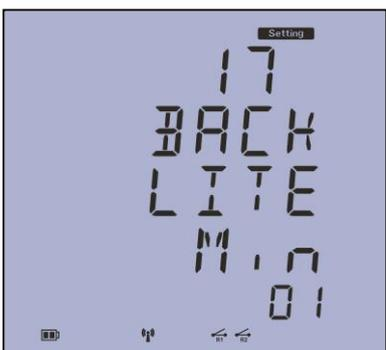
صفحه هفدهم: این منو زمان روشن بودن نور پس زمینه LCD را تنظیم می نماید که از ۱ تا ۱۵ دقیقه متغیر است و مطابق شکل بر روی ۱ دقیقه تنظیم شده است و پس از آن اتوماتیک نور پس زمینه خاموش می شود.
