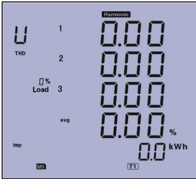
دکمه H را فشار دهید. وارد صفحات مربوط به اندازه گیری هارمونیک خواهید شد و بصورت مقابل هارمونیک مجموع ولتاژ (THD) برای هر فاز بصورت مجزا و نیز مقدار متوسط آن نمایش داده میشود
