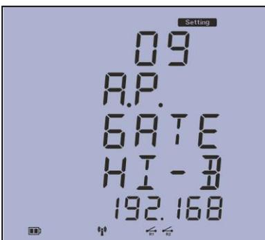
صفحه نهم: این صفحه جهت وارد نمودن GATEWAY اختصاصی ACCESS POINT و ورود ۶ رقم با ارزش بالاتر بکار میرود.
