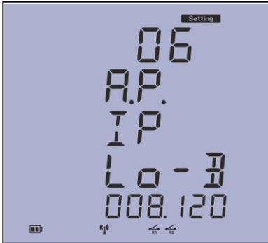
صفحه ششم: این صفحه جهت وارد نمودن IP اختصاصی ACCESS POINT و ورود ۶ رقم با ارزش پایینتر بکار میرود.
