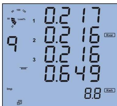
صفحه دوم: نمایش توان راکتیو هر فاز شامل Q3, Q2, Q1 , Q کل سیستم می باشد.
