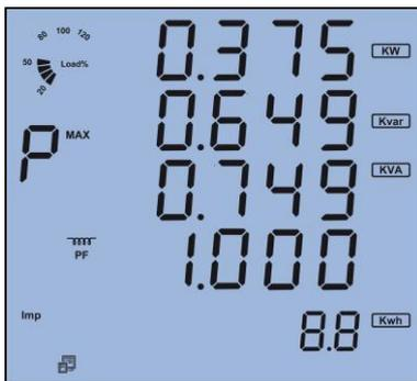
صفحه چهارم: مقادیر بیشینه توان و پاور فاکتور مطابق شکل ۲۹-۳ مقدار بیشینه توان کل سیستم  $P-max=0.375w$  و مقدار بیشینه توان راکتیو سیستم  $Q-max=0.649Kvar$  و مقدار بیشینه توان ظاهر سیستم  $S-max=0.749KVA$  و مقدار بیشینه پاور فاکتور  $PF-max=1.00$  می باشد با فشار دکمه P از نمایشگر max به نمایشگر min می رویم.
