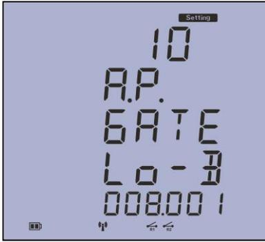
صفحه دهم: این صفحه جهت وارد نمودن GATEWAY اختصاصی ACCESS POINT و ورود ۶ رقم با ارزش پایین تر بکار میرود.
