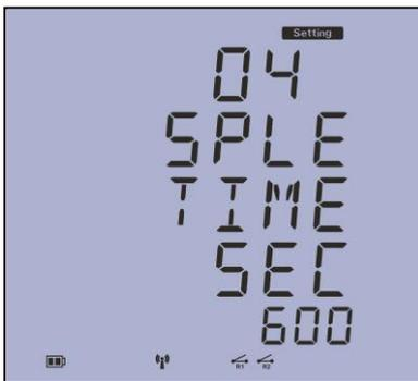
صفحه چهارم: زمان فاصله ما بین ثبت دو رکورد از اطلاعات اندازه گیری شده می باشد. که با مشخصات دقیق زمانی روی فلش محوری ثبت می شوند که این فاصله زمانی می تواند از ۱ ثانیه تا ۹۰۰ ثانیه (۱۵ دقیقه) تنظیم گردد. بعد از طی فاصله زمانی مشخص شده یک رکود با مشخصات ذیل ذخیره می شود: تاریخ دقیق، ساعت دقیق، Frequency, PFt, PF3, PF2, PF1, St, S3, S2, S1, Q3, Q2, Q1, Pt, P3, P2, P1, ... و Hn, I3, I2, I1, V32, V23, V12, V3, V2, V1
