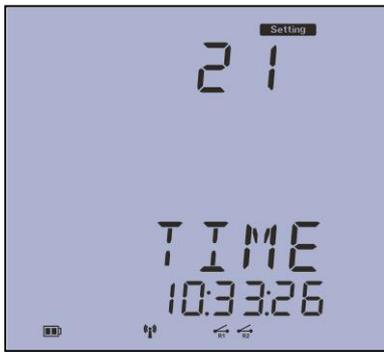
صفحه بیست و یکم: منوی تنظیم ساعت دستگاه که مطابق شکل روی صفحه ۱۰:۳۳:۲۶ تنظیم شده است و با دکمه H روی ساعت و دقیقه و ثانیه رفت و با P و E افزودن و کاهش مقادیر و بعد از ثبت دقیق با دکمه V به منوی بعدی می رویم.
