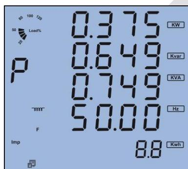
صفحه ششم: توان کل سیستم  $P_{sum}$  و توان راکتیو سیستم  $Q_{sum}$  و توان ظاهری مجموع سیستم  $S_{sum}$  و فرکانس سیستم  $F$  نمایش داده می شود که مطابق شکل ۱۱-۳ بصورت زیر است.
