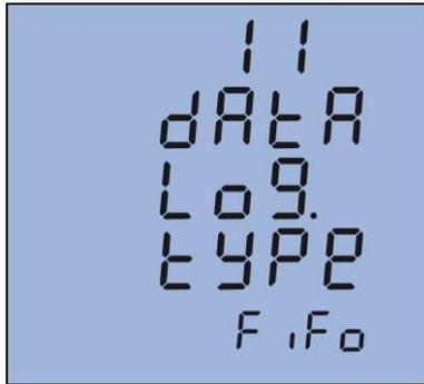
صفحه یازدهم: منوی تنظیم نحوه ذخیره سازی داده ها را نمایش می دهد. شما می توانید نحوه ذخیره داده ها را روی حافظه داخلی دستگاه در این منو تنظیم نمایید. اگر روش FIFO انتخاب شود در این صورت اگر فلش داخلی دستگاه پر شود دستگاه داده جدید را به ترتیب روی قدیمی ترین داده ذخیره می کند و همواره آخرین داده ها را به شما خواهد داد. اما اگر روش FILL AND HOLD انتخاب شود عملیات ذخیره سازی تا پر شدن حافظه داخلی ادامه داشته پس از آن متوقف می شود.
