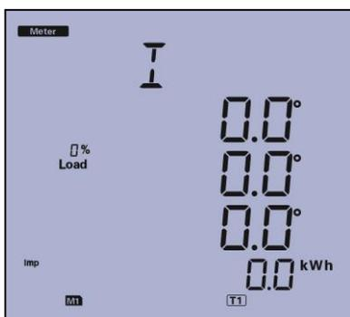
صفحه چهاردهم: در این صفحه مقدار نامتقارنی بین فازها برای جریان شبکه در هر فاز بصورت درجه اندازه گیری و نمایش داده میشود.
