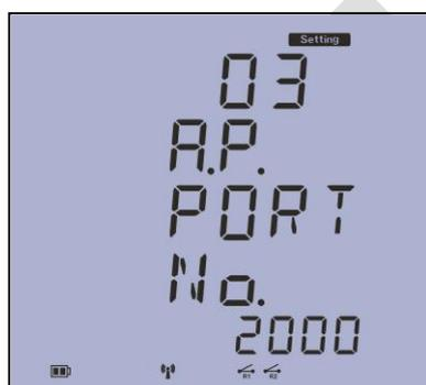
صفحه سوم: این صفحه جهت اختصاص شماره پورت ACCESS POINT استفاده میشود. که در تنظیمات نرم افزار دستگاه مورد نیاز استو باید مطابقت این پورت جهت اتصال از طریق wi-fi بررسی شود.
