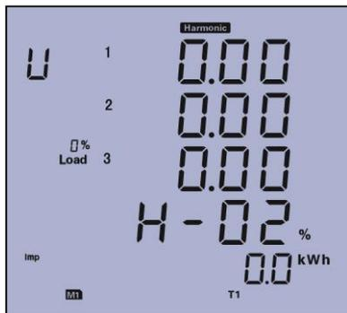
صفحه شانزدهم: در این صفحه مقدار هارمونیک دوم ولتاژ برای هر فاز نمایش داده میشود و تا هارمونیک شانزدهم با فشار دگمه H قابل نمایش است.
