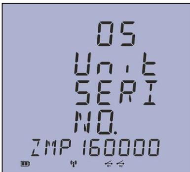
صفحه پنجم: این صفحه نشان دهنده شماره سریال یونیک اختصاص یافته به دستگاه توسط شرکت میباشد. که جهت فعال سازی دستگاه و تبدیل از حالت ACCESS POINT به STATION در ارتباطات از طریق بستر ارتباطی TCP-IP جز موارد مورد نیاز میباشد.
