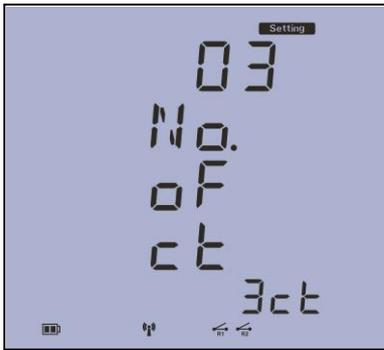
صفحه سوم: صفحه تنظیم ورودیهای جریان می باشد. که دارای دو مدل انتخاب می باشد. 3ct و 4ct. (مراجعه به فصل ۲) مطابق شکل نوع ورودی جریان با 3ct انتخاب شده است که با دکمه E و P می توان به 4ct تغییر داد.
