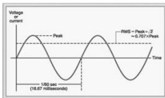
عبارت فوق صرفاً یک تعریف ریاضی برای محاسبه کرسٹ فاکتور بود، اما واقعا محاسبه این پارامتر به چه دلیل در صنعت اهمیت دارد؟ بدلیل وجود بارهای غیرخطی و منابع مختلف تولید هارمونیک در بارهای مختلف، الزاما تمام شکل موج‌ها سینوسی نخواهند بود به عنوان مثال حتی اگر یک ولتاژ کاملا سینوسی به یک بار غیرخطی اعمال شود جریان کشیده شده از یوپی‌اس غیر سینوسی خواهد بود. در زیر نمونه‌ای از یک شکل موج جریان غیرخطی نشان داده شده است.
