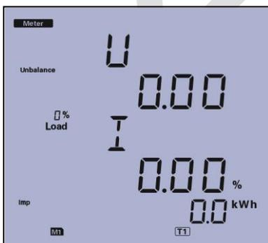
صفحه یازدهم: در این صفحه مقدار نامتقارنی برای جریان و ولتاژ شبکه اندازه گیری و نمایش داده میشود
