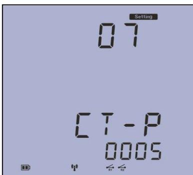
صفحه هفتم: منوی تنظیم مقدار اولیه CT می باشد که می تواند مقداری بین ۵ تا ۸۰۰۰ داشته باشد. واحد آن آمپر و مطابق شکل بر روی ۵ آمپر تنظیم شده است با فشار دکمه P و E امکان تغییر مقادیر وجود دارد. با فشار دکمه V مقدار ثبت شده و به صفحه بعد می رویم.
