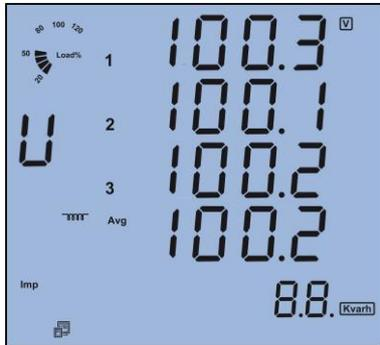
صفحه اول : نمایش دهنده  $V_a, V_b, V_c, V_{avg}$  که بصورت مقابل نمایش داده شده است.
