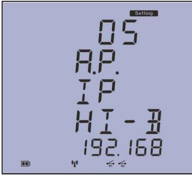
صفحه پنجم: این صفحه جهت وارد نمودن IP اختصاصی ACCESS POINT و ورود ۶ رقم با ارزش بالاتر بکار میرود.
