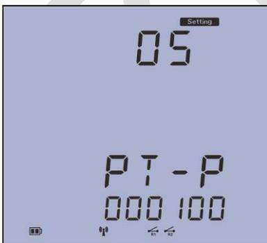
صفحه پنجم: منوی تنظیم مقدار اولیه PT می باشد که می تواند مقداری بین ۱۰۰ تا ۴۰۰،۰۰۰ باشد. واحد آن ولت می باشد و مطابق شکل بر روی ۱۰۰ تنظیم شده و با کلیدهای P و E امکان تغییر مقادیر وجود دارد. با فشار دکمه V مقدار ثبت شده و به صفحه بعد می رویم.
