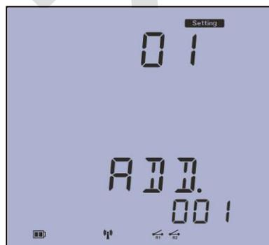
توجه: هر دستگاه اندازه گیری در شبکه RS485 باید یک آدرس منحصر بفرد داشته باشد که این بنا به ضروریات پروتکل Modbus-RTU می باشد.
