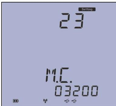
صفحه بیست و سوم: ضریب مخصوص چراغ چشمک زن جلوی دستگاه که متناسب با انرژی مصرفی چشمک زده و جهت سنجش انرژی بکار میرود.
