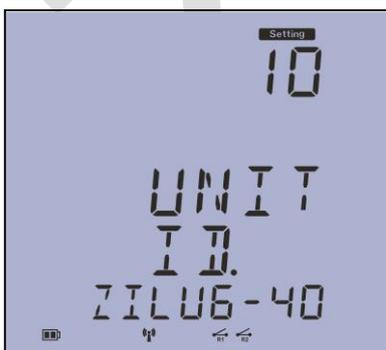
صفحه دهم: منوی تنظیم آی دی هر دستگاہ را نشان می دهد. اپراتور می تواند برای هر دستگاہ یک آی دی منحصر بفرد را انتخاب نماید. این آی دی جهت ساخت فولدر با نام آن دستگاہ روی فلش USB بکار رفته و باعث سهولت آنالیز اطلاعات چندین دستگاہ که بر روی فلش مشترک اطلاعات آن تخلیه شده می شود و این آی دی از ۸ دیجیت که می توان حروف بزرگ و اعداد را انتخاب کرد ساخته می شود.
