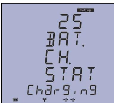
صفحه بیست و پنجم: نشان دهنده وضعیت باتری پشتیبان داخلی دستگاه میباشد. که در صورت full نبودن بحالت charging در میاید.
