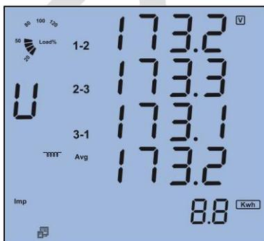
صفحه سوم: نمایشگر میان ولتاژهای خط به خط می باشد.  $V_{avg}$
