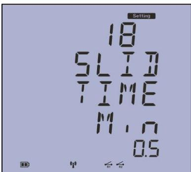
صفحه هیجدهم: این منو زمان دیمانداگیری از مقادیر اندازه گیری شده را نشان می دهد که از ۱ تا ۳۰ دقیقه قابل تنظیم است و دستگاه دیماندا کمیت را در بازه زمانی تعیین شده ذخیره می نماید طبق شکل زمان دیماندا روی ۵ دقیقه تنظیم شده است.
