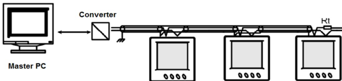
در شکل ۵-۲ مقاومت RT بعنوان مقاومت معکوس با مقدار ۳۰۰-۱۲۰ اهم بکار رفته است در حالتی که کیفیت ارتباطی کم باشد معمولاً این مقاومت به انتهای مدار در کنار آخرین ZMP نصب می شود.
