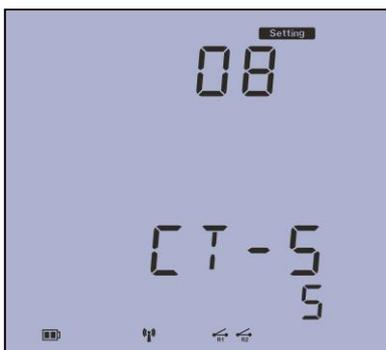
صفحه هشتم: منوی تنظیم میزان ثانویه CT که می تواند مقدار 1A یا 5A داشته باشد. واحد آن آمپر و مطابق شکل بر روی 5A تنظیم شده است. با فشار دکمه P و E امکان تغییر مقادیر بوده و با فشار دکمه V مقدار ثبت شده و به صفحه بعد می رویم.
