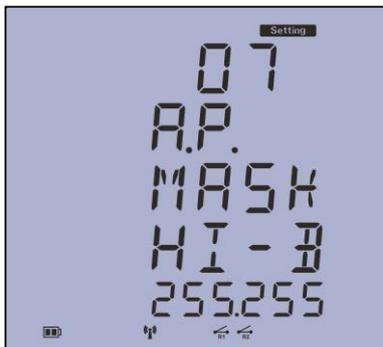
صفحه هفتم: این صفحه جهت وارد نمودن SUBNET MASK اختصاصی ACCESS POINT و ورود ۶ رقم با ارزش بالاتر بکار میرود.
