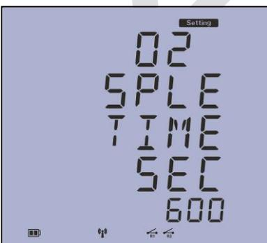
صفحه دوم : این صفحه مخصوص تنظیم زمان نمونه برداری جهت ذخیره پارامترهای اندازه گیری یا اصطلاحاً زمان لاگینگ بوده و از ۱ ثانیه تا ۹۰۰ ثانیه قابل تنظیم است. (دستگاه قادر به اندازه گیری و ثبت اطلاعات کلیه پارامترهای شبکه از هر ۱ ثانیه میباشد)
