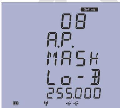
صفحه هشتم: این صفحه جهت وارد نمودن SUBNET MASK اختصاصی ACCESS POINT و ورود ۶ رقم با ارزش پایینتر بکار میرود.
