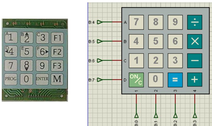
بر روی بردی که در اختیار دارید یک کی پد ۳\*۴ قرار داده شده است که به پورت D متصل می‌باشد و به راحتی می‌توان از آن استفاده کرد. بنابراین دیگر نیاز به تهیه کی پد خارجی نخواهد بود.
