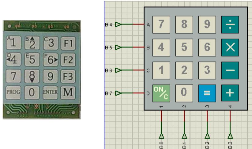
بر روی بردی که در اختیار دارید یک کی پد  $3 \times 4$  قرار داده شده است که به پورت D متصل می‌باشد و به راحتی می‌توان از آن استفاده کرد. بنابراین دیگر نیاز به تهیه کی پد خارجی نخواهد بود.
