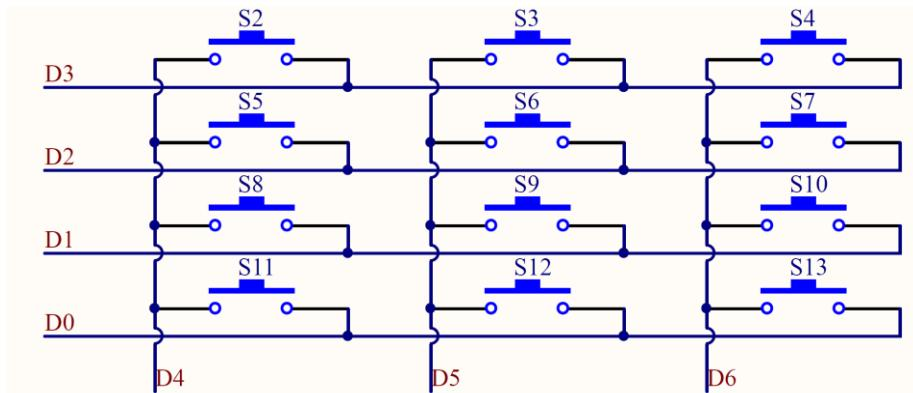
به دلیل اینکه کلیدها به صورت ماتریسی به هم متصل شده اند در نتیجه یک ستون را به صورت دستی صفر کرده و سپس می‌توانیم کلیدهای ردیف را چک کنیم.
