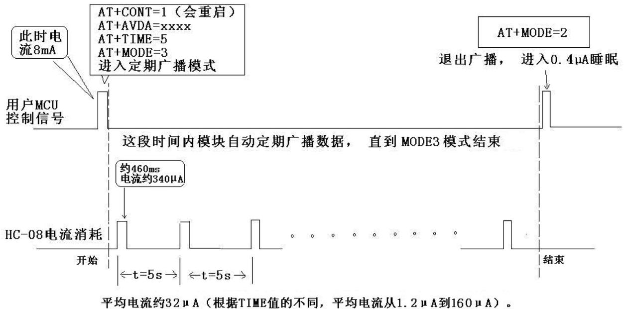
用户 MCU 给模块串口发送 10 个字节 16 进制码“0xFF, 0xFF, 0xFF, 0xFF, 0xFF, 0xFF, 0xFF, 0xFF, 0xFF, 0xFF”来唤醒模块，模块进入全速功耗模式。此时用户可以根据需要作合理设定，上面“AT+CONT=1, AT+AVDA=xxxx, AT+TIME=5, AT+MODE=3”设置为：广播而不可连接，广播数据为 xxxx，周期 5 秒的工耗模式 3。根据上图，要让平均电流<4μA，TIME 就要>1 分钟，时间越长，功耗越低。
